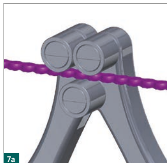
Rys. 7a i 7b: Kiedy płytka EickLoxx jest zginana w płaszczyźnie płytki, otwory pozostają okrągłe z powodu specjalnego mechanizmu szczyptic gnących z rolkami.
