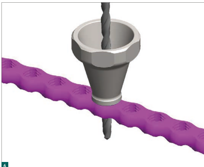
Rys. 6: Lej prowadzący wiertło jest wkręcany pionowo w gwint otworu w płycie. Za pomocą wiertła krętego można ustalić nachylenie śrub blokujących (do \pm 15^\circ obrotu wzdłużnego i poprzecznego).
