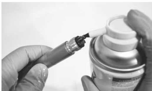
Wtryskiwanie oleju pielęgnacyjnego do kanału rękojeści za pomocą adaptera (olej konserwacyjny art. 174010, adapter art. 17401150)
