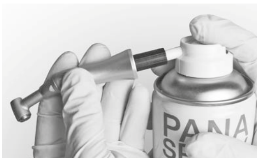
Wtryskiwanie oleju pielęgnacyjnego do rękojeści za pomocą adaptera (olej pielęgnacyjny art. 174010, adapter art. 17401155)
